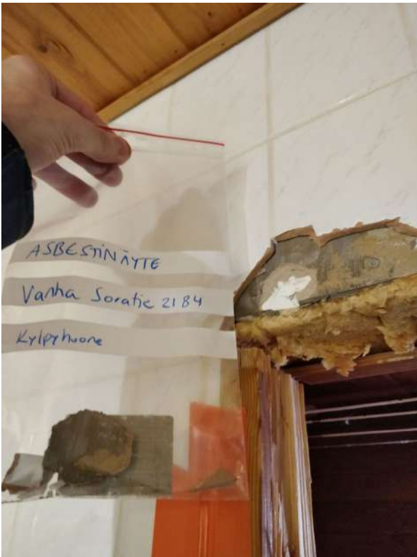
Teemu Hast 06.04.2020 13:29 Asbestinäyte.
